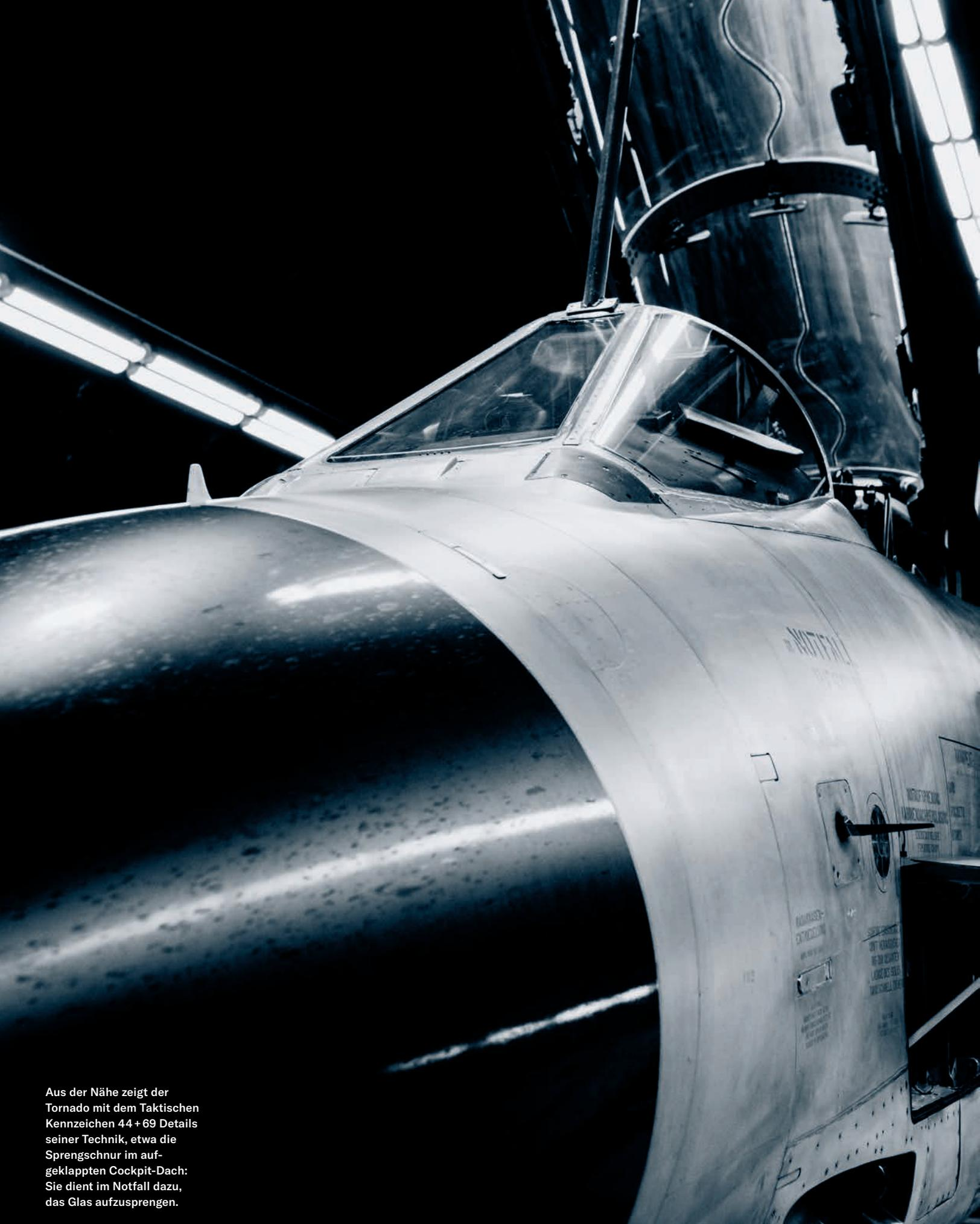
Aus der Nähe zeigt der Tornado mit dem Taktischen Kennzeichen 44 + 69 Details seiner Technik, etwa die Sprengschnur im aufgeklappten Cockpit-Dach: Sie dient im Notfall dazu, das Glas aufzusprengen.
